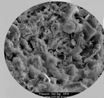
Probe schlickiger Fo-Horizont, Entenwerder: Die schlickige und sehr algenreiche Probe besteht aus vielen Einzelbestandteilen, z. B. ein Quarzkorn, an das Kieselalgen, Pyrit und Tonminerale angelagert sind. Auch einige kalzitische Komponenten sind gut zu sehen.
