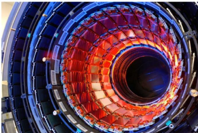
Abb. 6.27 Foto des CMS Streifendetektors von innen.
