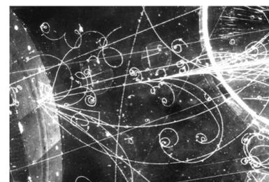
**Abb. C.35** Erzeugung eines Jets aus Hadronen in einer Blaskammer.
