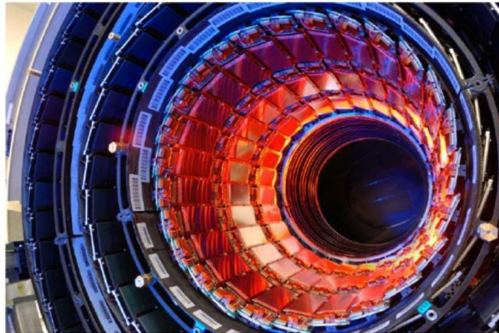
Abb. C.27 Foto des CMS Streifendetektors von innen.
