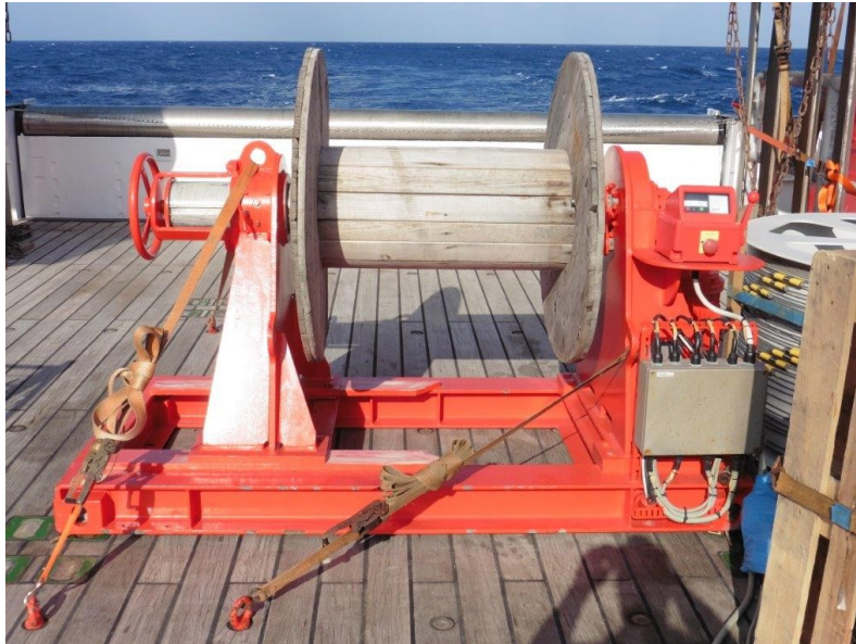
Bild: Mobiler Windenbock mit schiffseigener Holzhaspel
