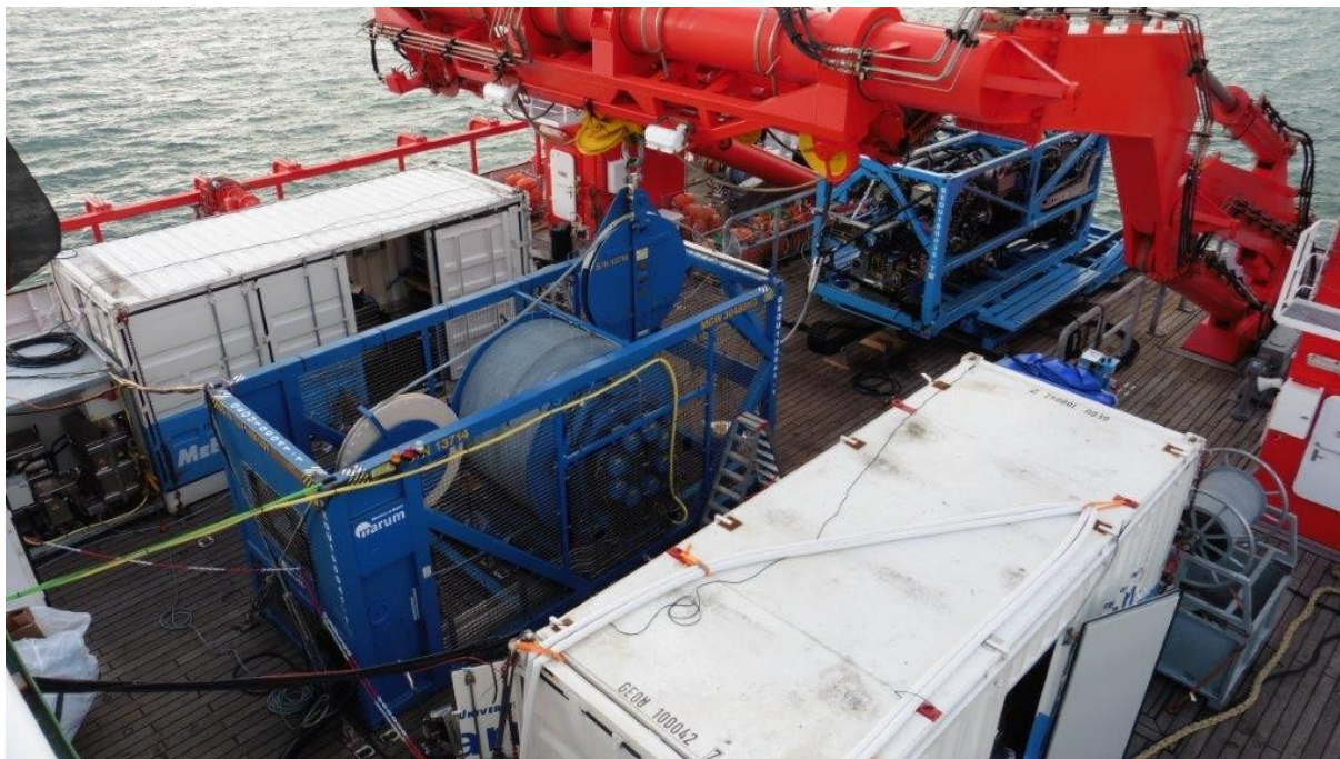
Anordnung MeBo 200 im Bereich des A-Rahmens
