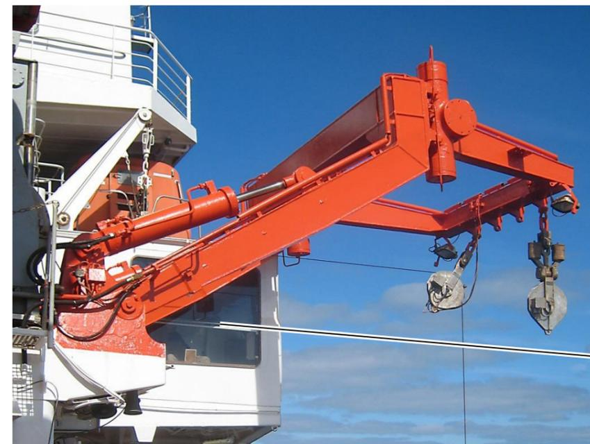
Fig. 14 FS METEOR, Seitenausleger mit Winschenanordnung und Seilführung
