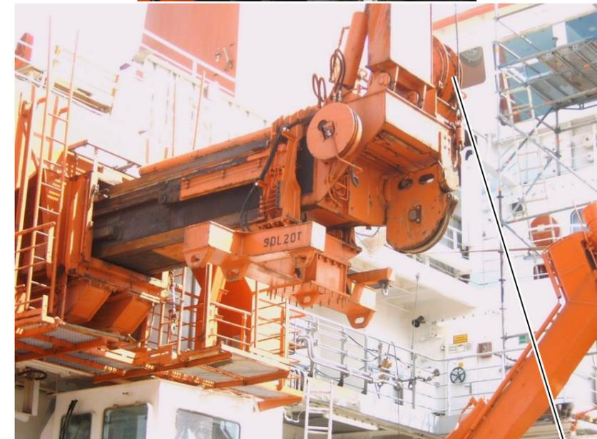
Fig. 15 FS METEOR, Schiebebalken
